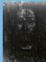
↑ Abbildung 3: Digitale Radiographie. Erkennbar sind die Fugen und die Holzmaserung der Tafel. Bereiche der Malschicht, die mit Bleiweiß ausgemischt wurden, sind als helle Struktur sichtbar. Weiße und graue Punkte sind Ausbrüche der Malschicht, die mit Kittmaterial aus Kreide und Bleiweiß geschlossen und dann retuschiert wurden. (Quelle: Dr. Pracher/Dr. Thevis, Reichenberg)
