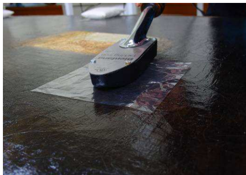
【圖十】以小頭熨斗加熱加壓熨平
