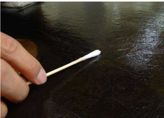
【圖十一】以清水移除多餘的膠
